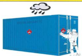
L'operatore applica la placca/pannello
