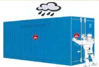
L'operatore applica la placca/pannello
